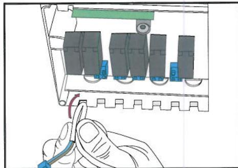
Fig. 4 Saml og skub kablet ind i kabelgennemføringen.
