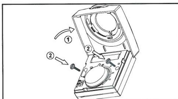
Fig. 2.b Rumtermostatens montering
